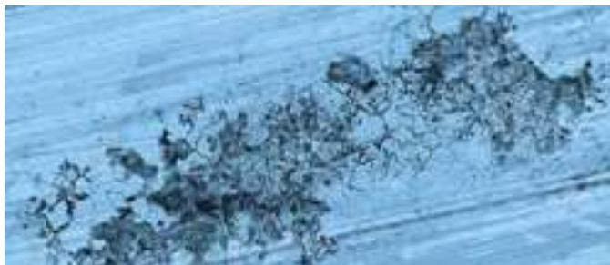
Los daños causados en los instrumentos de acero por las picaduras de corrosión debida al cloro son irreparables.
